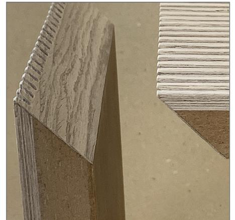
Milled P4/6/8/12 Board auf Gehrung z.B. eingepasstes Schubladenelement.
